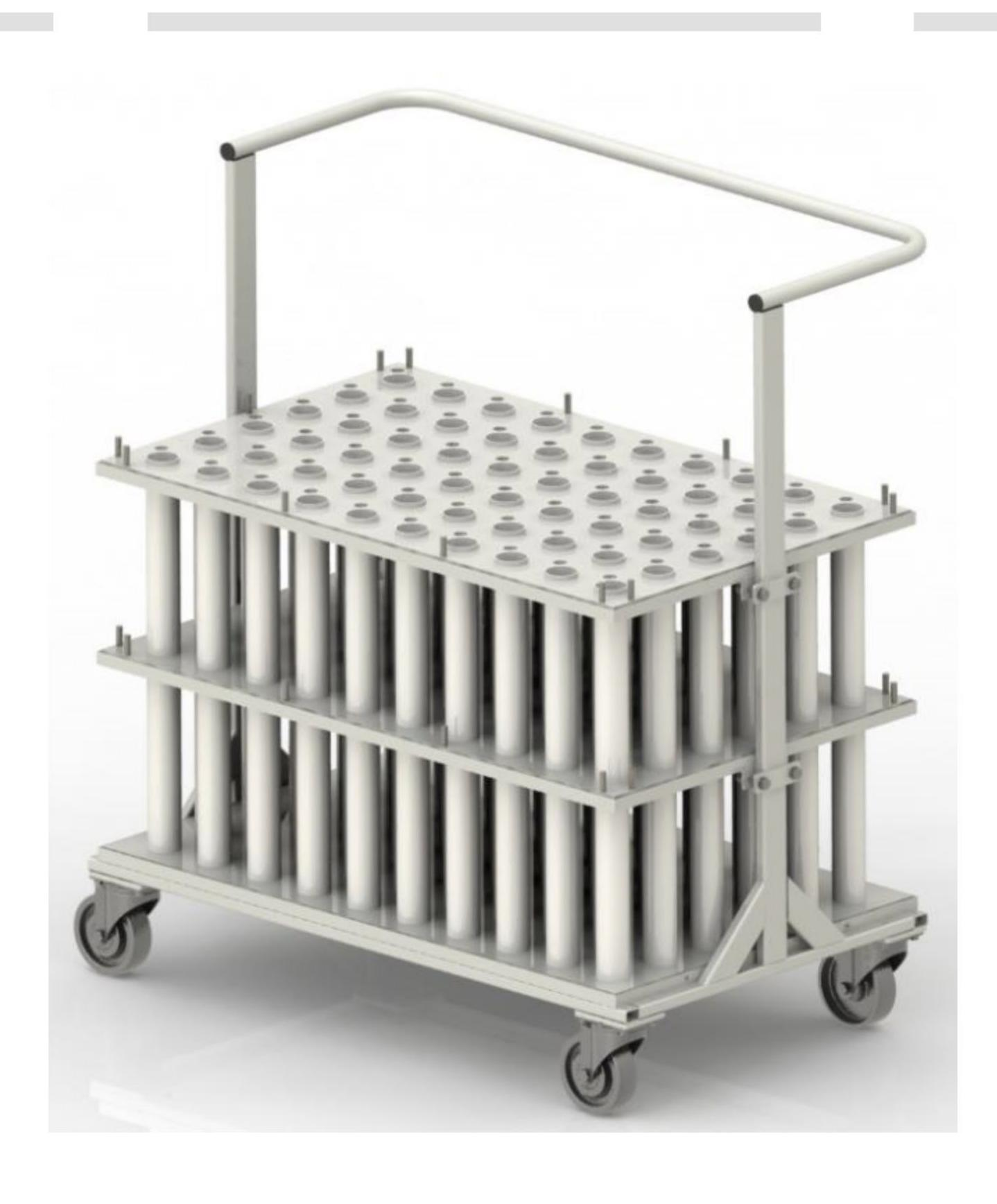
Wózek przeznaczony do pionowego transportu okuć Przegrody wykonane z rur PVC Podłoga z blachy Cztery poliamidowe koła skrętne, w tym dwa z hamulcem Wykończenie powierzchni: RAL 7035
