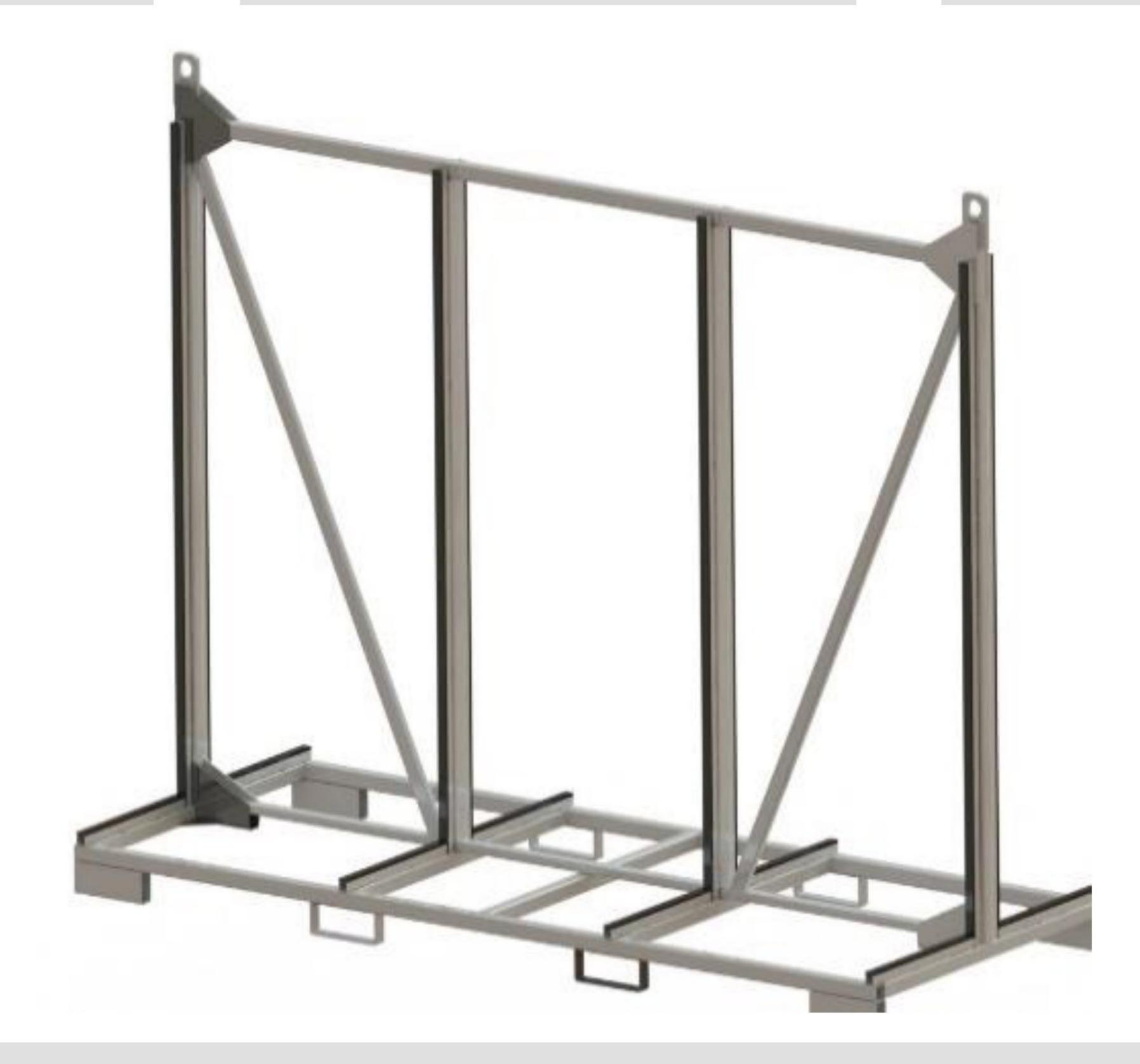
Stojak typu T, do transportu dużych konstrukcji fasadowych. W standardzie wyposażony w uszy pod widlak i suwnicę Podstawa wykończona profilem gumowym pełnym. Ściana wykończona profilem gumowym komorowym. Powierzchnia wykończenia : RAL 7035 lub Cynk ogniowy Nośność: zależna od typu
