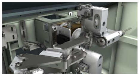
Wielonarzędziowa jednostka górna ze sterowaniem cyfrowym 01
